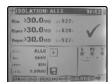
Automatische Messung des Isolationswiderstandes zwischen allen drei Leitern: L-N, L- PE und N- PE. Verschiedene Prüfspannungen: 50 V, 100 V, 250 V, 500 V und 1000 V mit dem Messbereich bis zu 1000 MΩ? Testzeit wird automatisch auf die getestete Objektkapazität eingestellt. Das Instrument entlädt automatisch die getesteten Objekte, nachdem der Test beendet ist.
