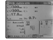
Eine Komplette RCD (FI- Schalter) Analyse kann automatisch in 6 Schritten durchgeführt werden. Die Prüfströme können von 10 mA bis 1000 mA und von dem 1/2- bis 5- fache des Nennauslösedifferenzstroms ausgewählt werden. Folgende Typen werden unterstützt (RCD-Typ G, S) Prüfungsstrom und Anfangspolarität:
