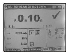
Niederohmwiderstandstest des PE- Leiters benutzt Neutralleiter und PE- Leiter. Die Messung an der Anlage unter Spannung wird mit dem Schuko- Commander durchgeführt. Das bedeutet, dass während der Niederohmwiderstandsmessung mit der AUTO SEQUENCE® die Anlage nicht ausgeschaltet werden muss. Der Prüfstrom kann zwischen 7 mA für Anlagen mit I<sub>dn</sub> 10. 100 mA von RCD oder Standard +/-200 mA Prüfstrom gewählt werden.
